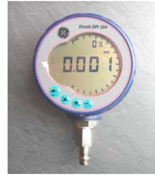
Capteur électronique pour l'étalonnage des manomètres de contrôle (classe 0,05)
